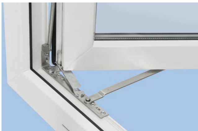
Dzięki przesunięciu osi obrotu zawiasów, okna otwierają się tak samo jak przy zastosowaniu okuć tradycyjnych.
