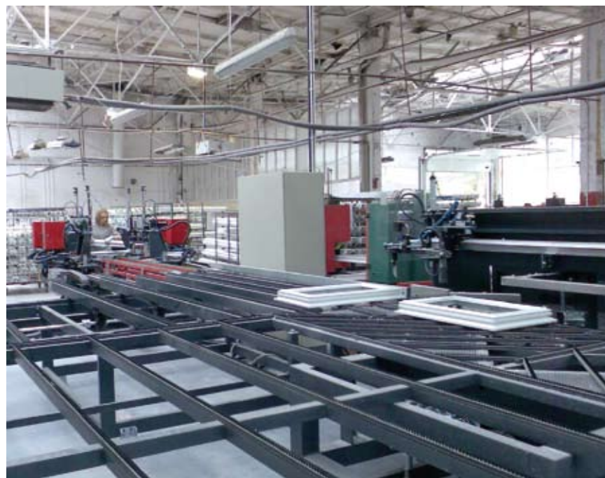
Automatyczna linia transportowa pomiędzy zgrzewarką i czyszczarką przyspiesza czas produkcji.
