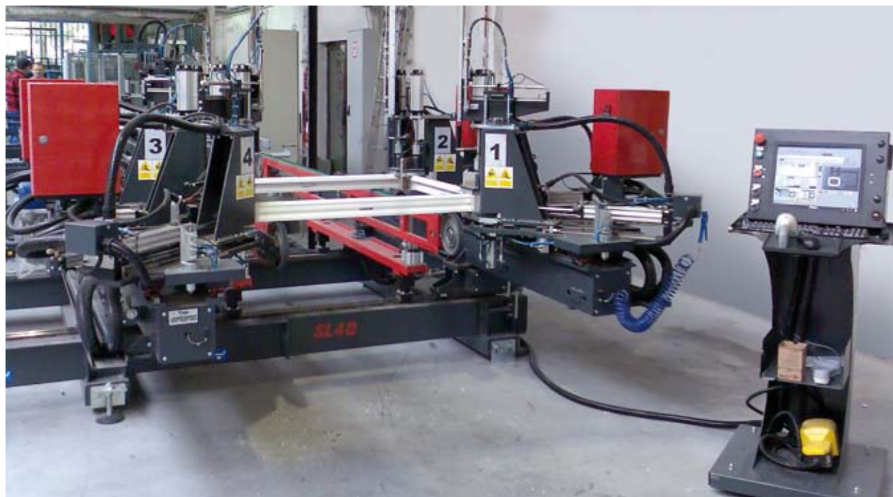
Zgrzewarka czterogłowicowa z korekcją wymiaru zgrzewu zwiększa dokładność i wytrzymałość gotowych ościeżnic i skrzydeł.
